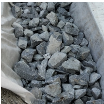
> Gros gravier non traité et concassé de 60 / 100 entouré par un géotextile.
